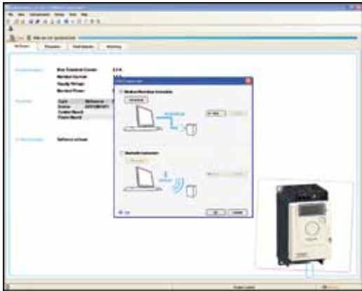
SoMove软件与ATV 12变频器连接示例
